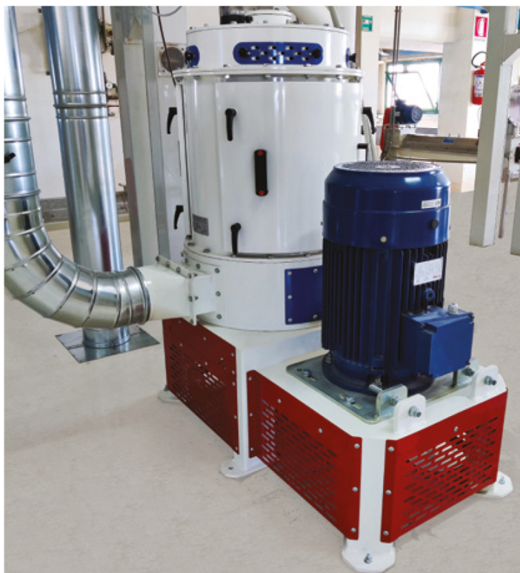
La decorticatrice MS-DECV27-6 installata presso il molino di un cliente (Molitecnica Sud).
